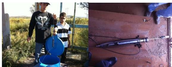
Los resultados de las mediciones de prueba de los levellogger, muestran una influencia notable en pozos que se bombean y que se localizan en las inmediaciones de los pozos donde se instalaron los levelloggers. En los datos de niveles graficados se observan periodos de abatimiento, seguidos de recuperaciones, esto es debido a la influencia del bombeo de pozos cercanos.
